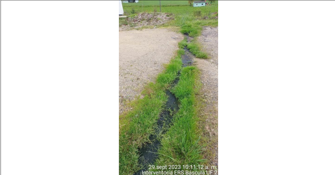
Ilustración 11 Presencia de línea de agua contigua al pozo séptico con alta presencia de materia orgánica
