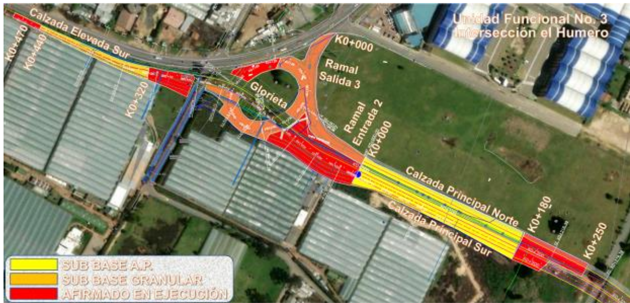
Gráfico 41 Avance en rellenos Unidad Funcional No. 3 – Intersección Humero.
