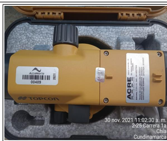
FOTOGRAFÍA N° 0010 FECHA: 30-nov.-21 DESCRIPCIÓN Verificación de equipos de topografía. Nivel Topcon AT-B4A WP077924.
