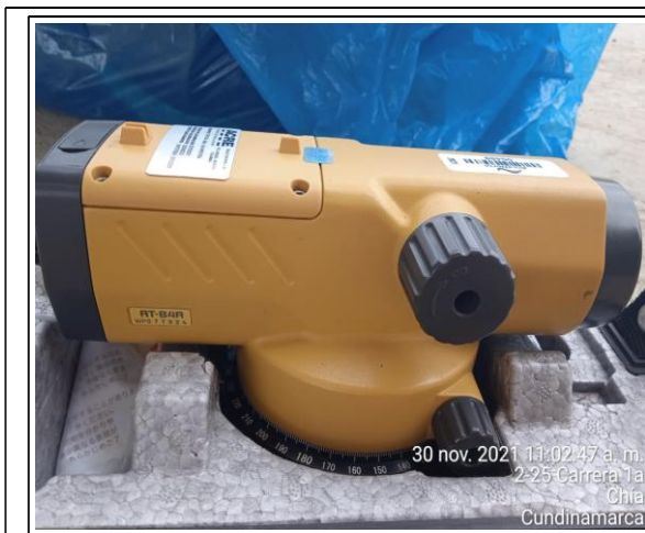
FOTOGRAFÍA N° 0009 FECHA: 30-nov.-21 DESCRIPCIÓN Verificación de equipos de topografía. Nivel Topcon AT-B4A WP077924.
