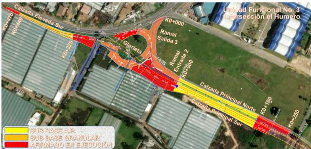
Gráfico 40 Avance en rellenos Unidad Funcional No. 3 – Intersección Humero.
