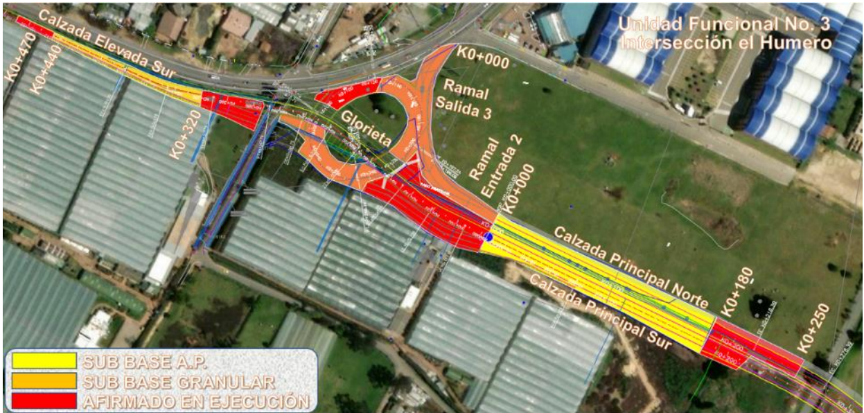
Gráfico 39 Avance en rellenos Unidad Funcional No. 3 – Intersección Humero.
