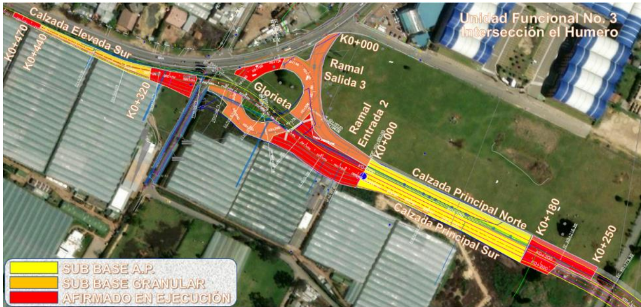
Gráfico 48 Avance en rellenos Unidad Funcional No. 3 – Intersección Humero.
