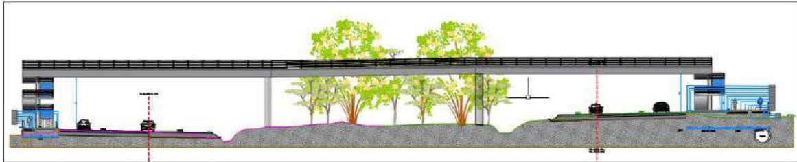
Gráfico 27 Sección Transversal Puente Peatonal Unicoc – UF2
