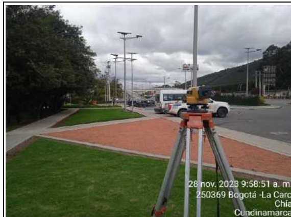
FOTOGRAFÍA N° 0012 FECHA: 28-nov.-23 DESCRIPCIÓN Verificación mensual de equipos de topografía de la Interventoría (Nivel de precisión).
