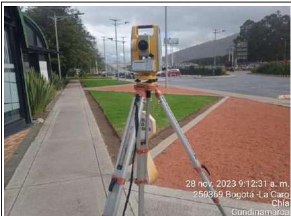
FOTOGRAFÍA N° 0011 FECHA: 28-nov.-23 DESCRIPCIÓN Verificación mensual de equipos de topografía de la Interventoría (Estación Total).
