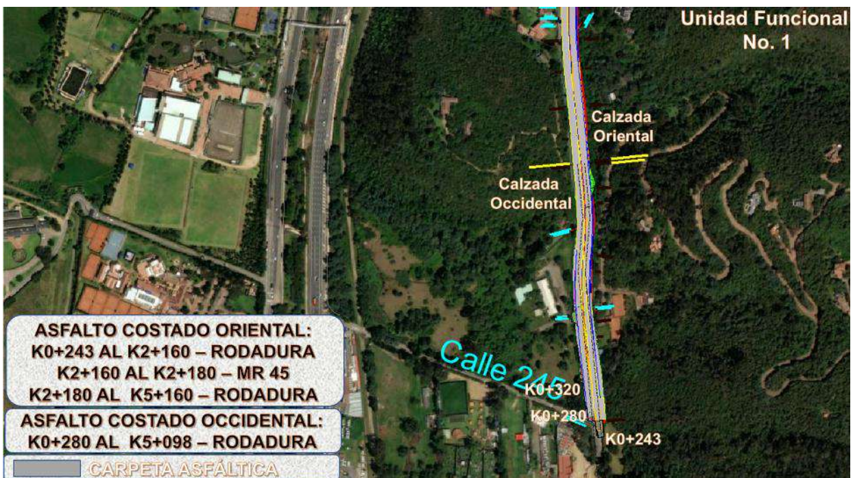
Gráfico 43 Avance intervención calzada Oriental y Occidental.
