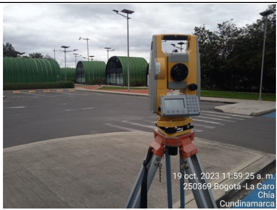
FOTOGRAFÍA N° 0007 FECHA: 19-oct.-23 DESCRIPCIÓN Verificación mensual de equipos de topografía de la interventoría. (Estación Total y Nivel de Precisión).
