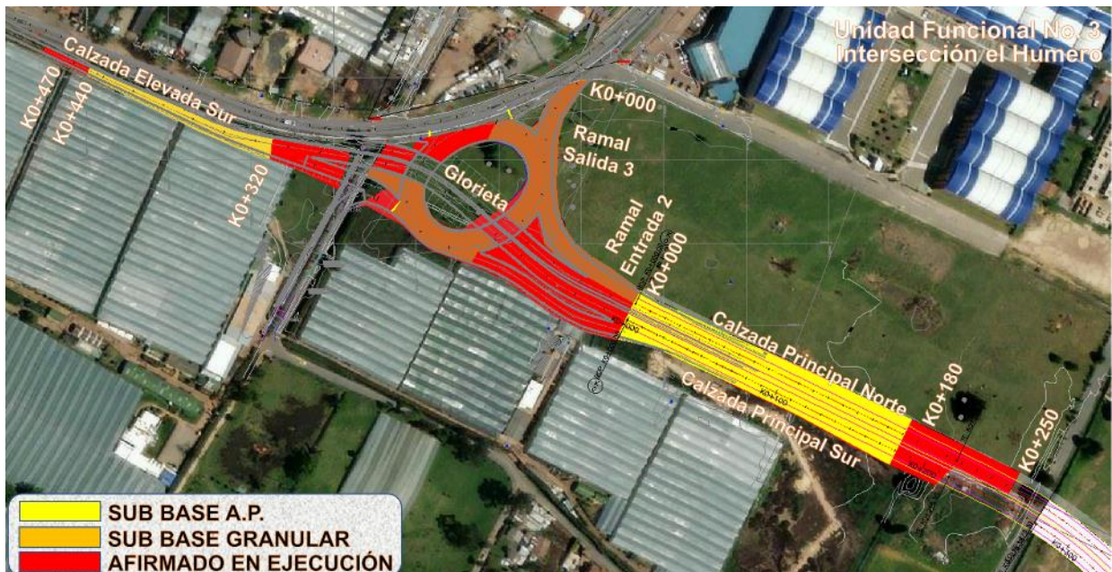
Gráfico 45 Avance en rellenos Unidad Funcional No. 3 – Intersección Humero.
