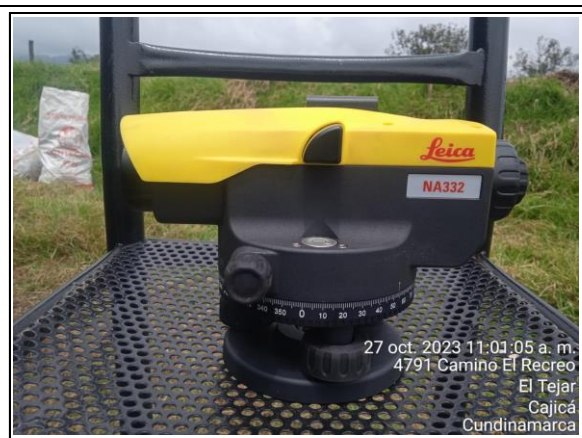
FOTOGRAFÍA N° 0008 FECHA: 27-oct.-23 DESCRIPCIÓN Verificación de equipos de topografía. Nivel Leica NA332.
