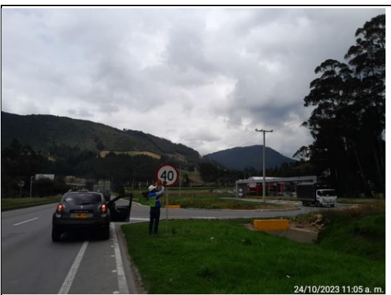
FOTOGRAFIA N° 0022 FECHA: 24/10/2023 RN 45ACNB PR 0+800 calzada occidental, medición del indicador E11 señalización vertical.
