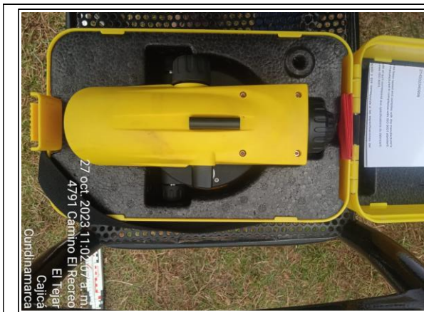
FOTOGRAFÍA N° 0007 FECHA: 27-oct.-23 DESCRIPCIÓN Verificación de equipos de topografía. Nivel Leica NA332.
