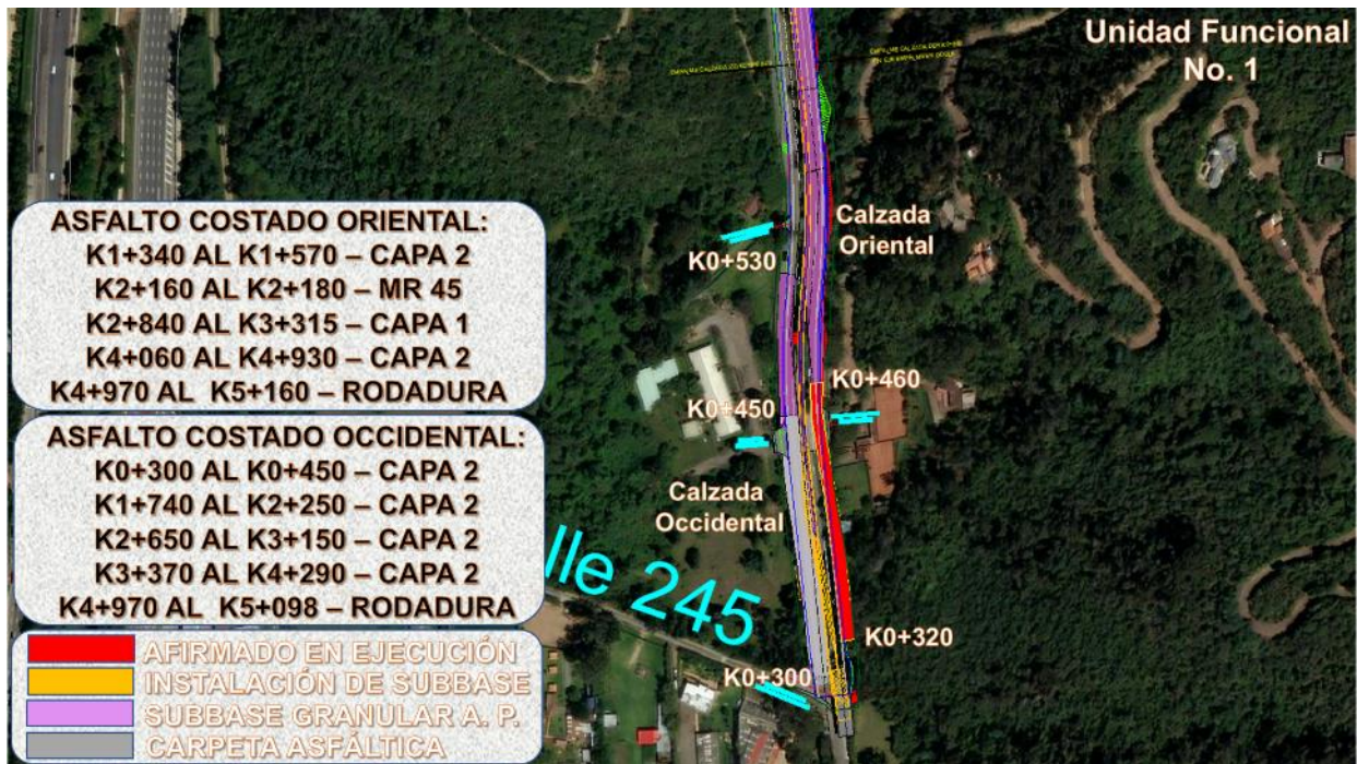
Gráfico 40 Avance de excavación y rellenos calzada Oriental y Occidental.
