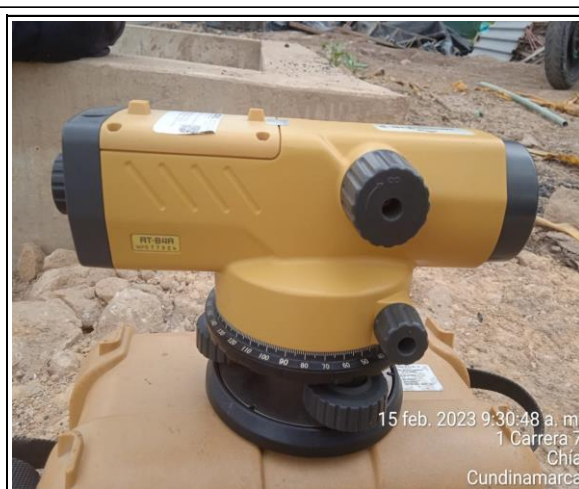
FOTOGRAFÍA N° 0010 FECHA: 15-feb.-23 DESCRIPCIÓN Verificación de equipos de topografía. Nivel Topcon AT-B4A WP077924.
