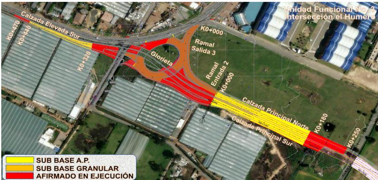
Gráfico 42 Avance en rellenos Unidad Funcional No. 3 – Intersección Humero.
