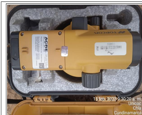
FOTOGRAFÍA N° 0009 FECHA: 15-feb.-23 DESCRIPCIÓN Verificación de equipos de topografía. Nivel Topcon AT-B4A WP077924.
