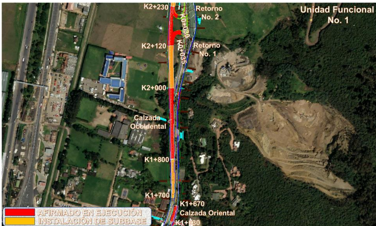
Gráfico 47 Avance de excavación y rellenos calzada Occidental.
