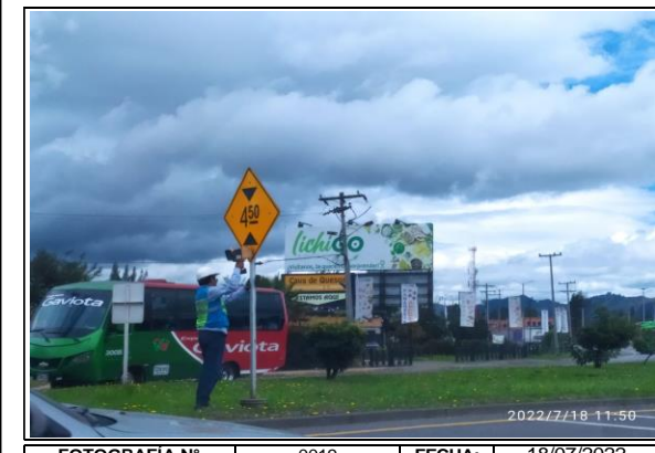
FOTOGRAFIA N° 0019 FECHA: 18/07/2022 RN 45ACNA, 45A04 Medición semestral del indicador E11 Señalización vertical, todas las señales del proyecto.
