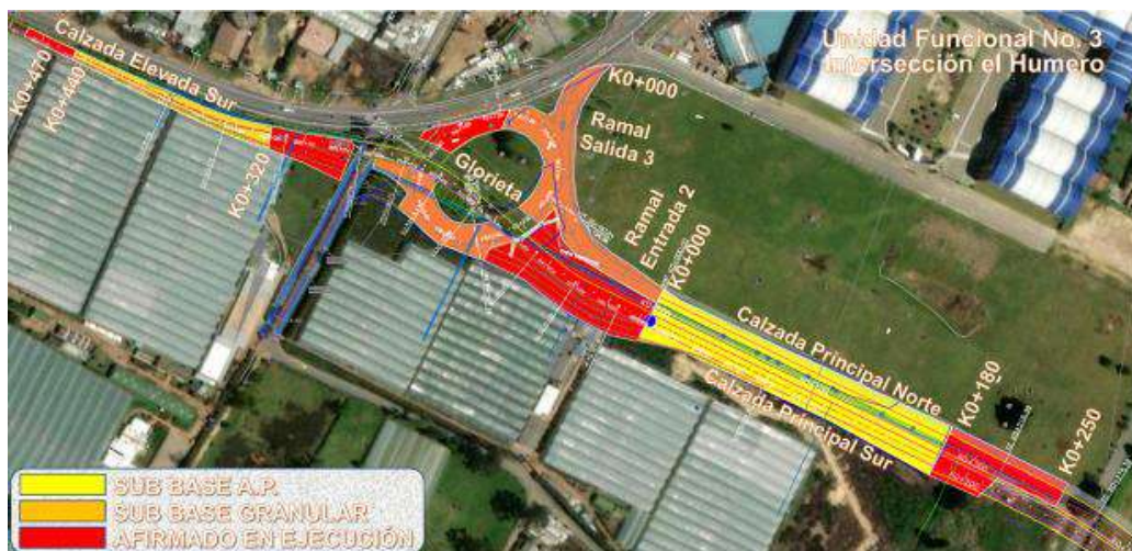
Gráfico 41 Avance en rellenos Unidad Funcional No. 3 – Intersección Humero.
